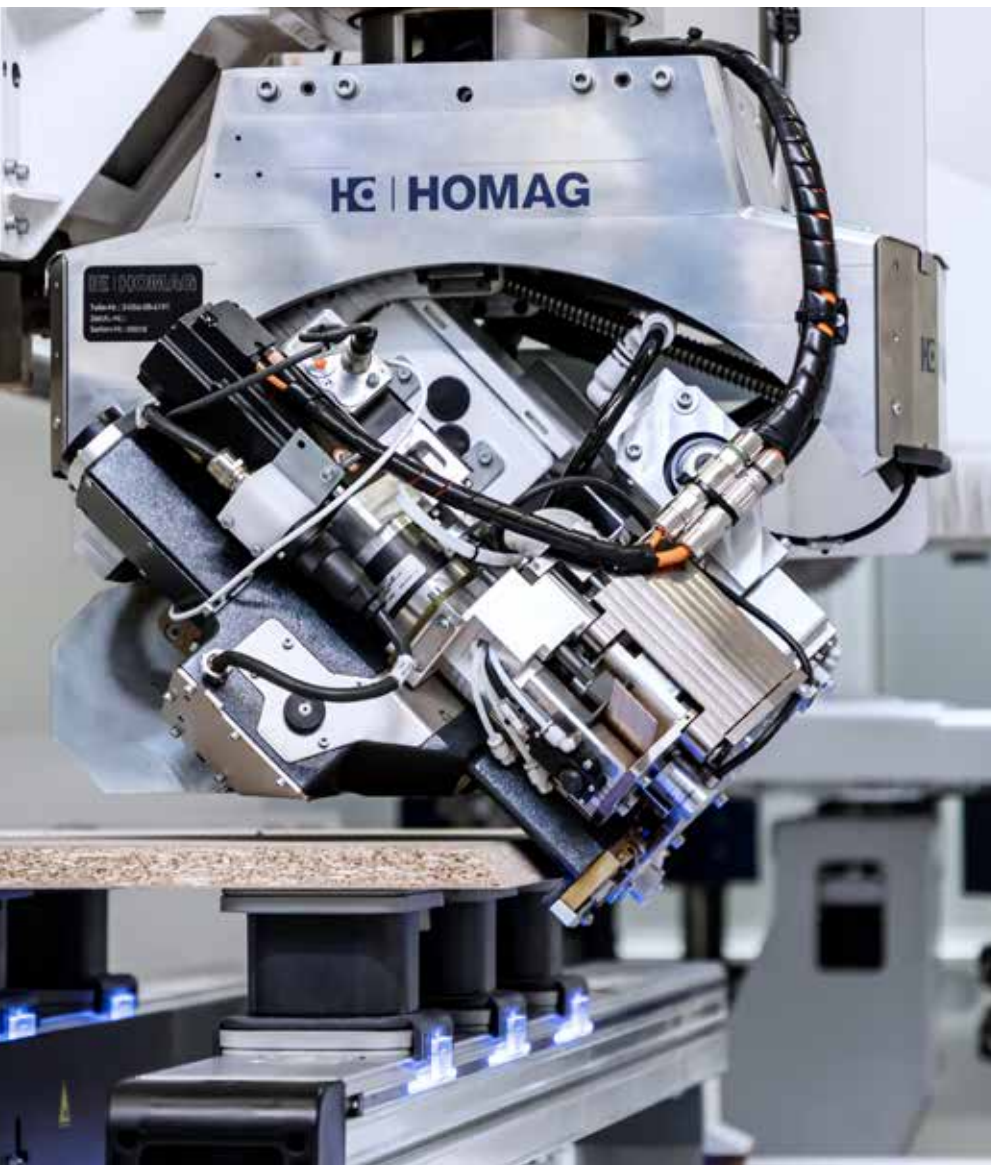
Chamfered edge gluing
